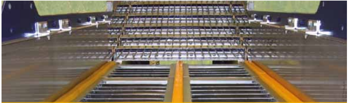
Das Schutzdeck als Schuppenrost mit/ohne Stangensizer. Das Unterdeck als SPANNWELL®-Siebbelag zur problemlosen Feintrennung.
