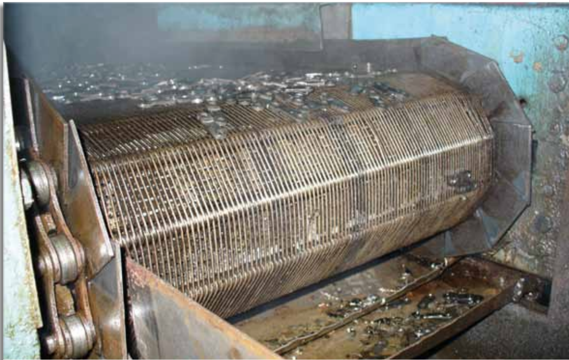
250,8/RZK mit gelochten U-Einlagen 250,8/RZK with perforated U-inserts
